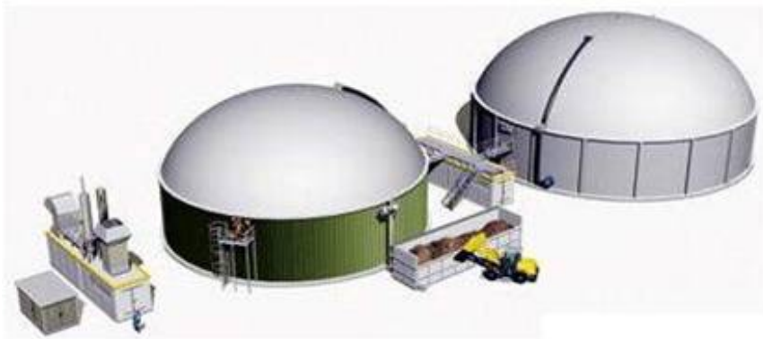
Figuur 6 Voorbeeld van een (co)vergistingsinstallatie.
