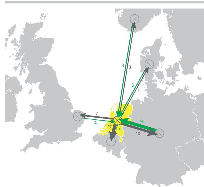
Figuur 2.8 Projectie van import en export van elektriciteit tussen Nederland en omliggende landen in 2025 (in terawattuur).
