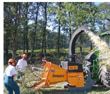
Schijvenhakselaar met manuele invoer met een rendement van 12 m³/u
