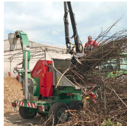
Trommelhakselaar met mechanische voeding met een rendement van 50 m³/u
